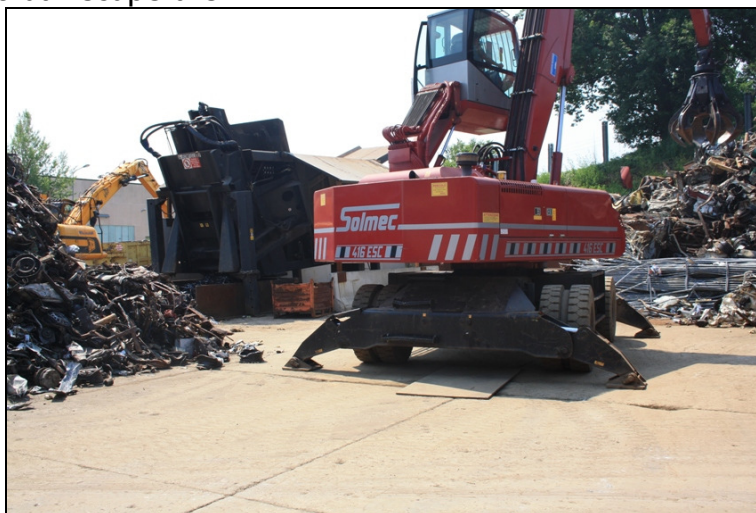
Immagine n.8) Caricatore semovente con ragno Solmec mod. 416 esc
